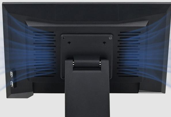
O design de dissipação de calor em ambos os lados do painel traseiro prolonga significativamente a vida útil do terminal POS.
